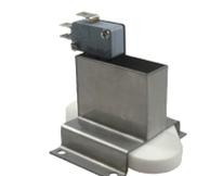
Contact à micro-rupteur, flotteur polystyrène expansé 24 x 86 mm, mesure à raz du fond, pour détection de fuite 18
